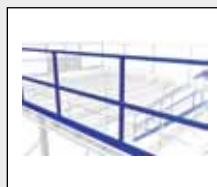
Räcke med sparkplåt
